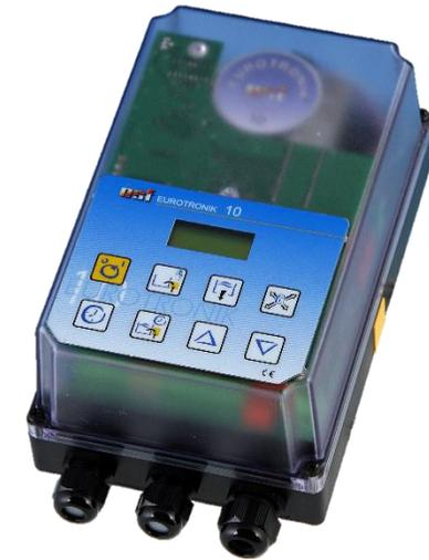
Commande de rétrolavage EUROTRONIK - 10
