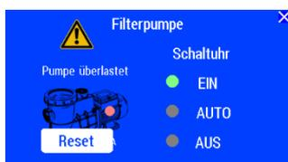
Appuyer sur le bouton « Reset » pour déverrouiller la protection du moteur déclenchée.
